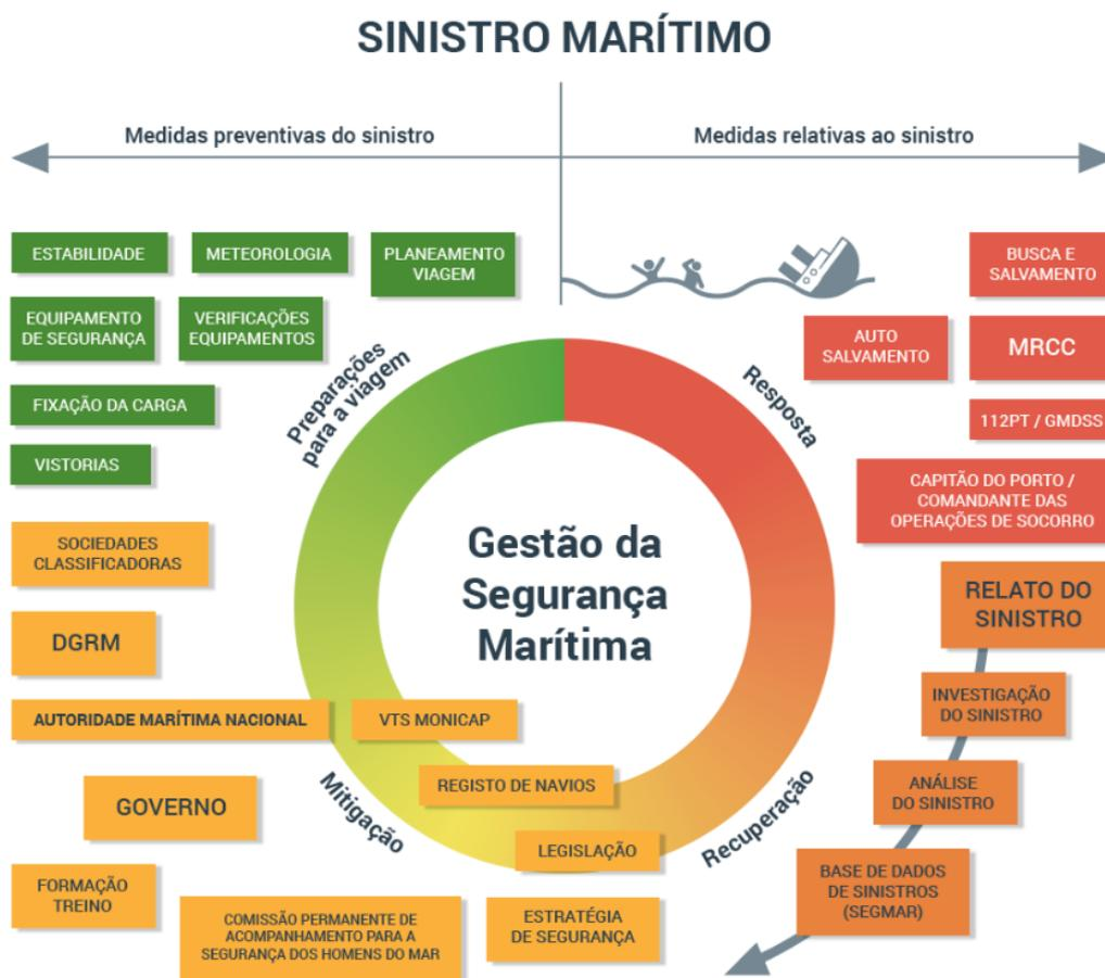
Legenda: A figura acima representa o modelo conceptual da segurança marítima com uma componente preventiva, desenvolvida com atividades de certificação inicial e vistorias de manutenção, e uma componente de resposta à emergência, consubstanciada na ação das embarcações salva-vidas integradas na organização SAR, a que se segue o inquérito ao sinistro marítimo e a investigação técnica de segurança do GPIAM e o registo em base de dados dessa informação para análise estatística e de tendência.
